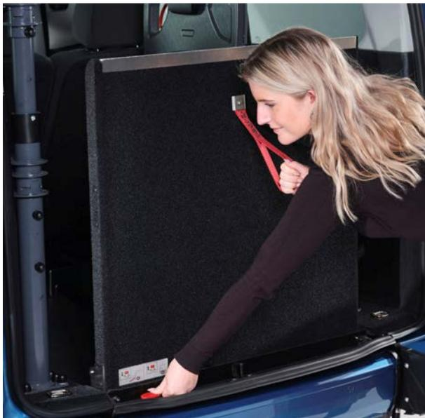
Figure 13 : Déverrouiller le cadre
