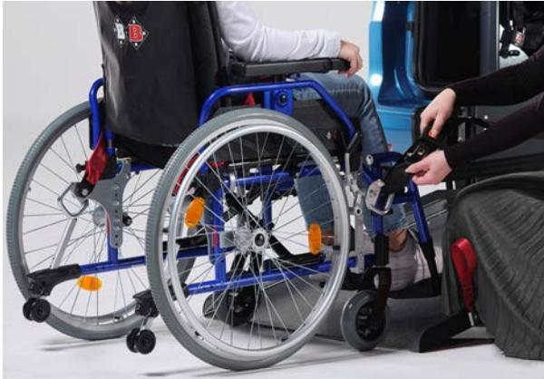
Figure 15 : Attacher les sangles électriques au fauteuil roulant
