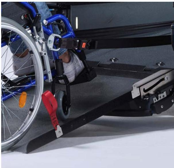
Figure 16 : Sangles électriques attachées au fauteuil roulant
