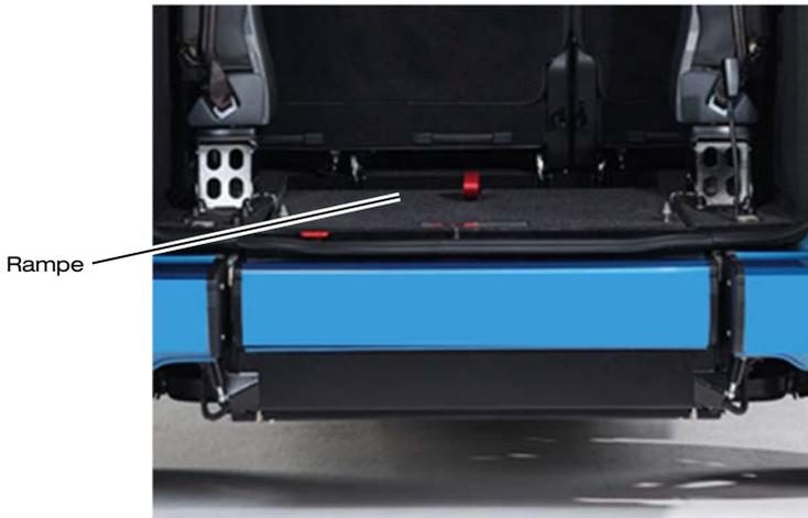
Figure 22 : Rampe entièrement repliée à l'intérieur (uniquement EasyFlex)
