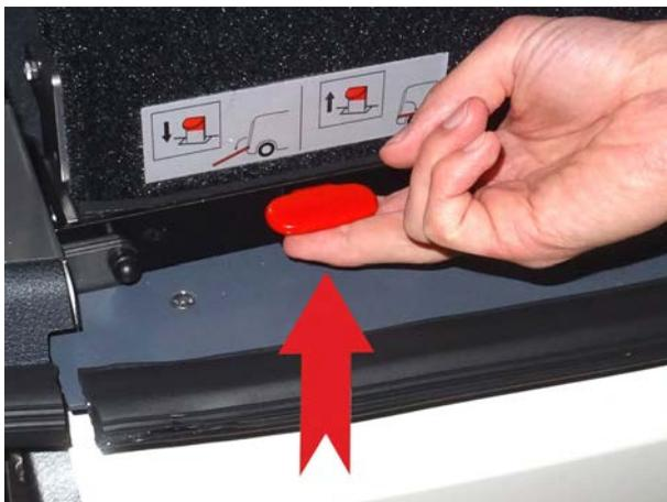
Figure 23 : Déverrouiller la rampe
