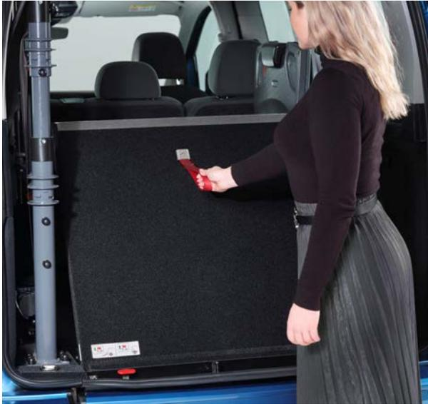
Figure 12 : Mettre la rampe en position verticale (uniquement EasyFlex)
