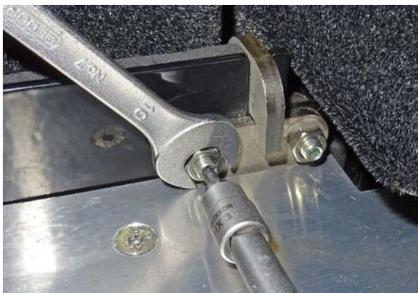
Figure 26 : Régler le jeu sur les vis de réglage
