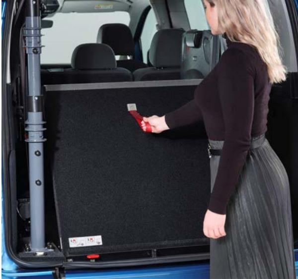
Figure 24 : Replier la rampe
