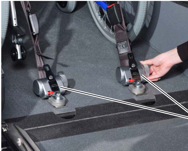
Figura 17: Tensionar os mecanismos de retração
