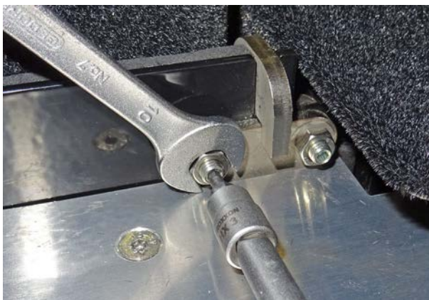
Figura 26: Ajustar a folga através dos parafusos de ajuste
