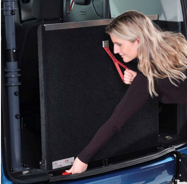
Figura 13: Desbloquear a estrutura
