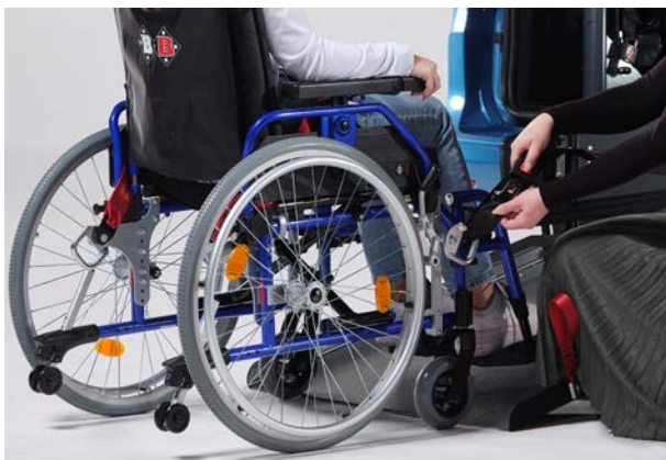
Figura 15: Fixar os cintos de segurança elétricos à cadeira de rodas
