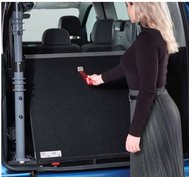
Figura 12: Colocar a rampa na posição vertical (apenas EasyFlex)
