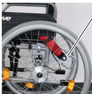
Figura 7: Cinto de segurança subabdominal independente do veículo (vermelho) em duas versões
