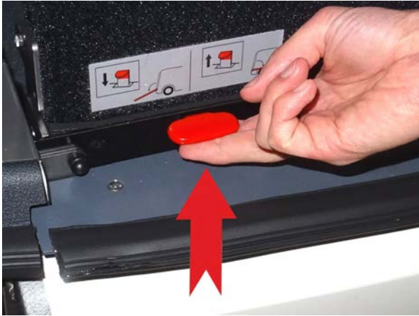
Figura 23: Desbloquear a rampa
