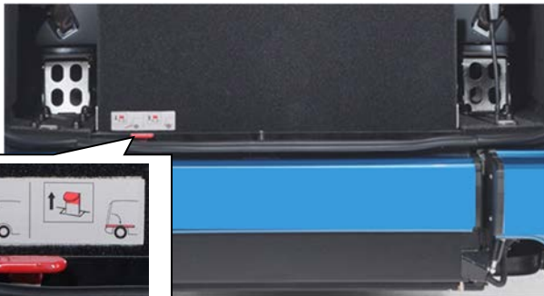
Alavanca de operação da "Rampa"
