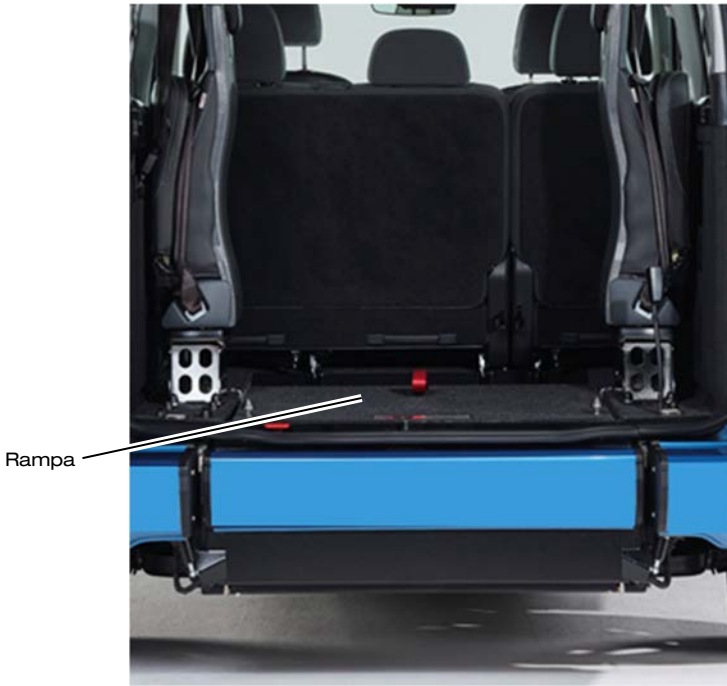
Figura 3: Rampa EasyFlex completamente dobrada para dentro
