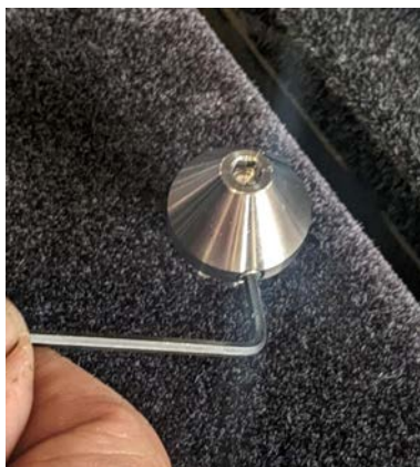
Soltar o parafuso de fixação
