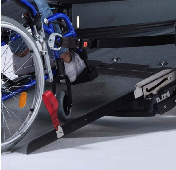
Figura 16: Cintos de segurança elétricos fixados à cadeira de rodas
