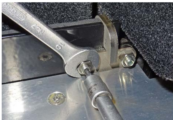
Illustrazione 26: Regolazione del gioco tramite le viti di regolazione
