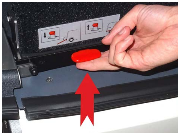
Figura 23: Desbloquear la rampa
